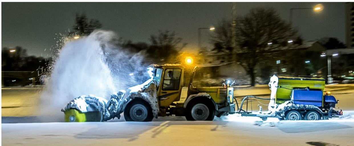
Figur 7. Sopsalting er å børste unna snøen og deretter spre salt som hindrer isdannelse. Metodikken gir under noen forhold barmarksforhold på sykkeltraséer året rundt, om den brukes riktig. Bildekilde: Niska & Blomqvist, 2019.
